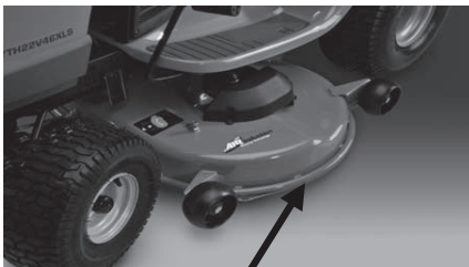
Coque d'unité de coupe étampée protégée par armure
